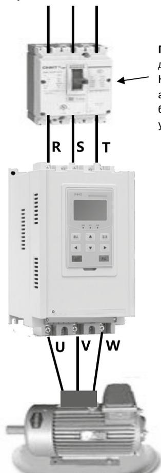
**Примечание.** Автоматический выключатель должен быть установлен в шкафу. Как правило, номинальный ток автоматического выключателя должен быть в 1,2 раза выше номинального тока устройства плавного пуска.
