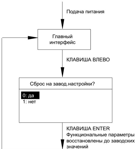
Рисунок 6.3а). Восстановление заводских значений параметров
